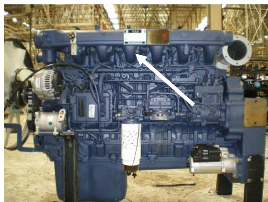
Место установки заводской таблички на двигателе WP12
