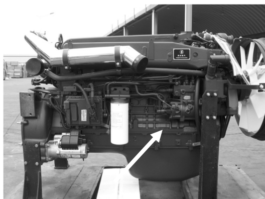
Место гравировки заводского номера на двигателе WP10
