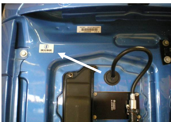
Места нанесения штрих-кодов (наклейки этикеток)
