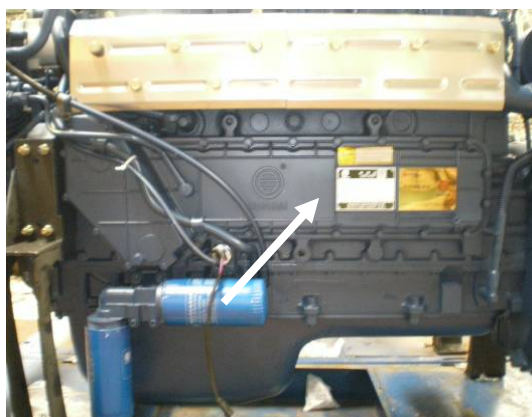
Место установки заводской таблички на двигателе WP10
